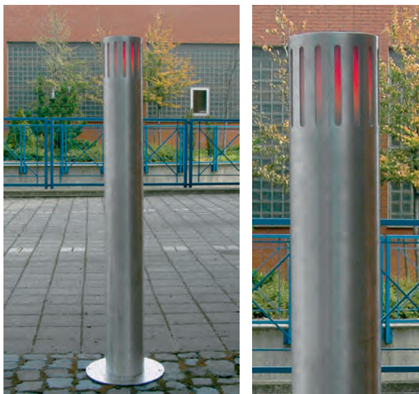
Poller mit integrierter dreiflämmiger Beleuchtung in LED-Technik: rot-gelb-grün zur Signalisierung der Betriebszustände
