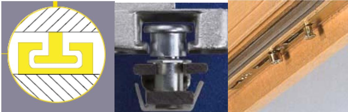
Bei Neu- oder Umbau wird der Einbau von einbruchshemmenden Fensterelementen empfohlen. Einen hohen Widerstand wird durch Pilzkopfbeschläge und Zwillingsbolzenverschlüsse erreicht.
